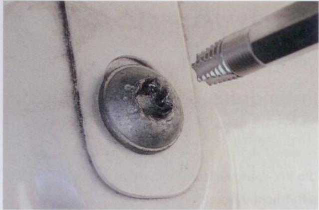
**Für hoffnungslose Fälle:** TX-Schraubenköpfe, die aufgrund von Korrosion oder Unachtsamkeit beschädigt wurden, sind mit dem neuen TX-Inbus-Schraubenausdreher wieder lösbar.
