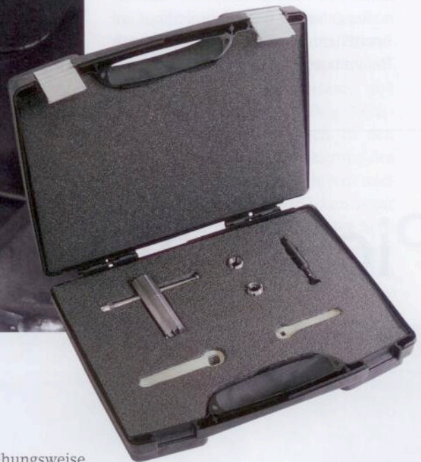
Für leckfreien Ölwechsel: Mit dem Ölablassschrauben-Dichtsitz-Planfräsersatz von HBT kann der Kfz-Profi einen beschädigten Dichtsitz an der Ölwanne nacharbeiten. Bilder: HBT
