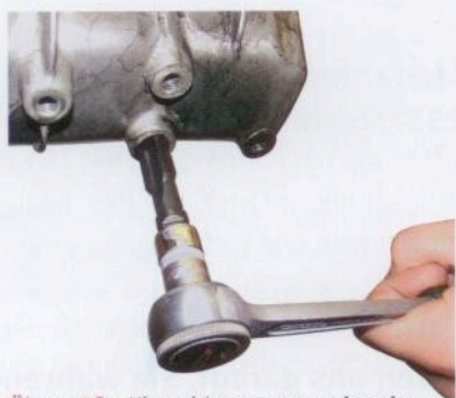
Übergroße: Klann bietet entsprechende Gewindebohrersätze mit Übermaß-Ablassschrauben sowie Dichtringen an (rechts). Mit dem größeren Gewindebohrer bohrt der Mechatroniker das beschädigte Ölwannegewinde auf (oben). Bilder: Klann
