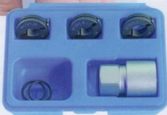
Im Gegensatz zu herkömmlichen Gewindeschneidern kann dieses Werkzeug auf den hinteren (unbeschädigten) Gewindegängen aufgesetzt und damit nach vorne durchgeschnitten werden. Damit eignet sich das Reparaturset besonders für das Instandsetzen von Radbolzen und -schrauben, deren vordere Gewindegänge schadhaft sind. Platzsparend und praktisch aufbewahrt ist das Set in einer im Lieferumfang enthaltenen Box. Das Gewindereparaturset für Stehbolzen ist über den Teilegroßhandel zu beziehen. *tm*
