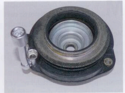
HBT Spezialwerkzeug: Gegenhaltewerkzeug für Domlager
