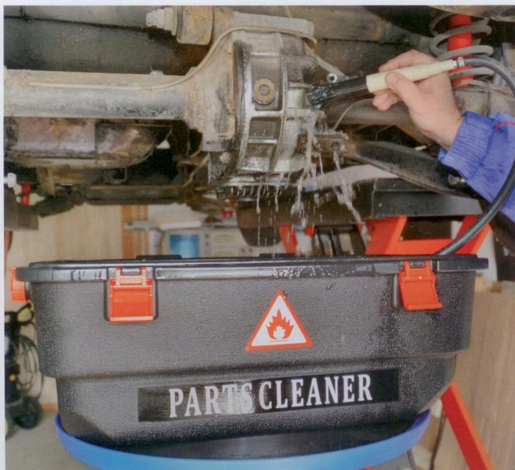
**Gehobene Stimmung:** Die Kombination mehrerer Spezialwerkzeuge, hier ein mobiles Teilwaschgerät auf einem Getriebeheber mit zusätzlich montierter Arbeitsplatte, erleichtert manche Arbeiten ungem. Bild: Mareis
