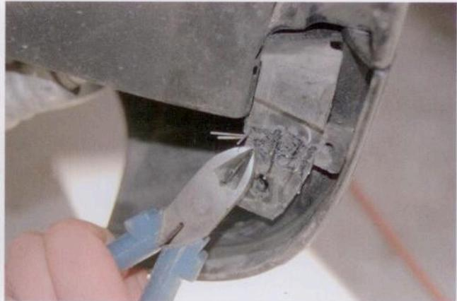
**Sollbruchstelle:** Die überstehenden Enden der Edelstahlklammern kürzt der Kfz-Profi mit einem Seitenschneider oder bricht sie an den vorgestanzten Einkerbungen ab.
