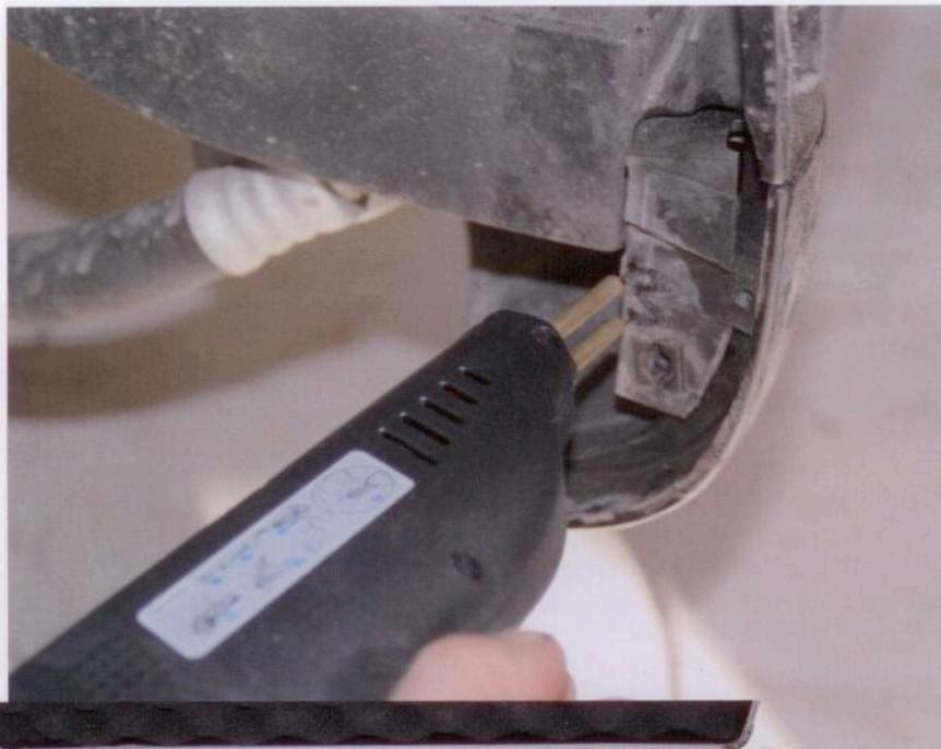
**B**eschädigungen an Kunststoffteilen, etwa abgebrochene Befestigungslaschen an den Scheinwerfern oder gerissene Stoßfänger, erfordern in der Werkstattpraxis häufig den Austausch des kompletten Bauteils. Im Smart-Repair-Sektor oder im Rahmen einer Gebrauchtwagenaufbereitung stellt sich aus Kostengründen jedoch die Frage nach zeitwertgerechten Reparaturmöglichkeiten.
