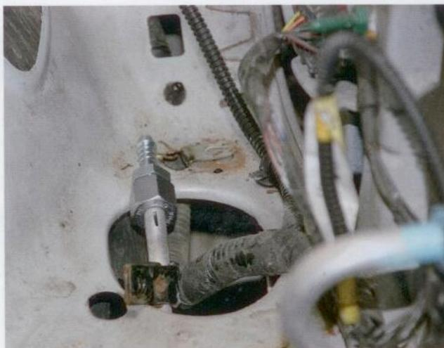
**Aufnahmebereit:** Auf das fertig montierte Fitting kann nun der Schlauch aufgeschoben werden.
