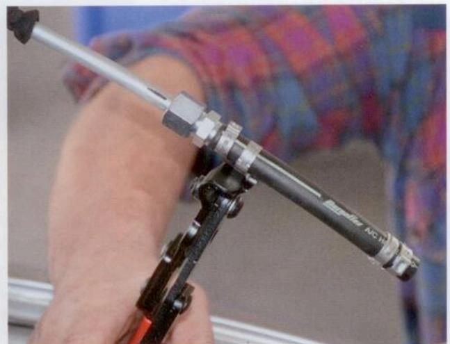
**Alles dicht:** Die dem Reparatursatz beiliegenden stufenlosen Oetiker-Einrohrklemmen aus Edelstahl fixieren den Schlauch druck- und verschiebesicher auf den Fittings.
