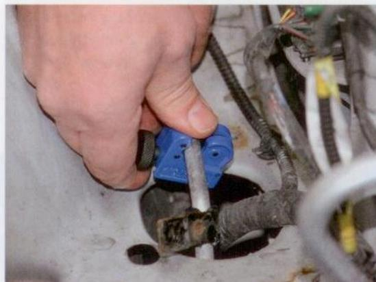
**Klarer Schnitt:** Mittels eines passenden Rohrschneiders entfernt der Profi das undichte Teilstück. Der Einsatz einer Säge oder anderer spanabhebender Werkzeuge sind hierfür tabu!
