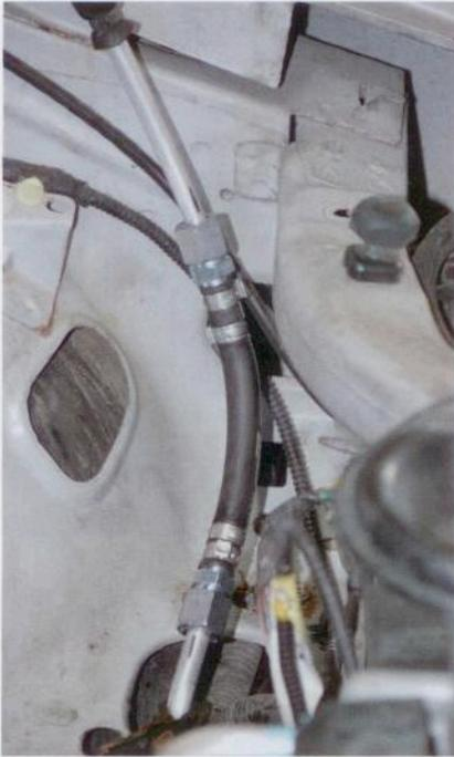
**Fertig zur Wiederbefüllung:** Das Reparaturstück ist eingebaut, die Klimaanlage fast wieder betriebsbereit.
