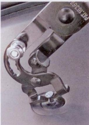
Die Clip-Entfernerzange eignet sich für die Demontage von Clips und Niete mit einer Größe von bis zu 17 mm. Bild: Kunzer
