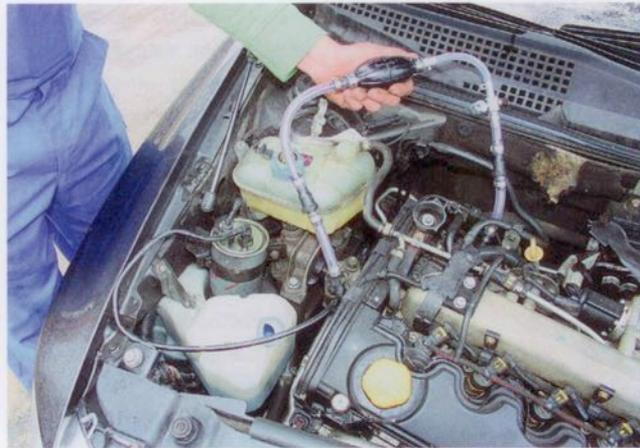
Der Entlüftungs- und Vorbefüllungssatz eignet sich für Wartungsarbeiten am Dieseldieselkraftstoffsystem. Bild: KS Tools
