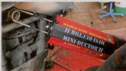
satzweise gefährdet wären. Für größere Teile wird anstelle der Induktionsspule einfach ein flexibles Induktionskabel montiert. Das geniale Profigerät kostet 1178 Euro.
