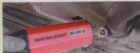
Gegen festgerostete Schrauben und Muttern hat Werkstattausrüster *Kunzer* das „Induktions-Heizgerät MD-800-GE“ entwickelt. Die festgegammelten Verschraubungen werden, statt für einen hochroten Kopf beim Schrauber zu sorgen, mit dem Heizgerät zielgerichtet und gut dosierbar erwärmt, die Korrosion in den Gewindegängen auf diese Weise dauerhaft losgebrochen. Um selbst einen kühlen Kopf zu bewahren, muss man aber 990 Euro lockermachen...
