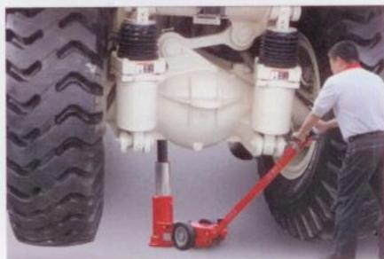
Die Sonderheber sind für Baumaschinen mit einem Gewicht von bis zu 70 t geeignet.
