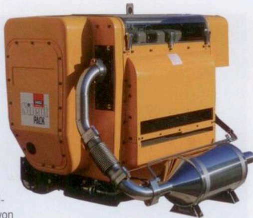
Prototyp eines 4L43C-Motors mit Dieselpartikelfilter.
