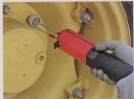
Mit Hilfe des Induktions-Heizgeräts können stark angerostete Schrauben ohne Beschädigung des Umfelds demontiert werden. Foto: Kunzer
