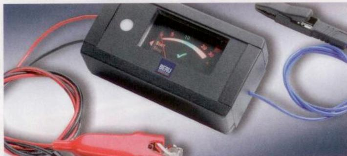
**Beru:** Der Glühkerzen-Tester ermöglicht eine schnelle Prüfung ohne Ausbau. Die Steuerungslogik erkennt verschiedene Kerzentypen und stellt die passende Prüfspannung ein. Der Motor muss dabei nicht gestartet werden, das Display verdeutlicht das Ergebnis durch Rot/Grün-Umschaltung.
