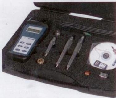
Das neue Kompressions- und Verlustdruckmessgerät „Compri“ der Imes GmbH ermöglicht es, Kompressions- und Verlustdruck bei Benzin-, Diesel- und Gasmotoren zu messen und zu testen. Als Multifunktionsgerät konzipiert, erlaubt Compri aber auch, Drücke in allen flüssigen Medien am Motor zu messen. Das Gerät kann Drücke bis 70 bar erfassen. Der Sensor ist resistent gegen Dieselöl, Benzin, Schmieröl, Bremsflüssigkeit, Hydraulikflüssigkeit und natürlich Luft
