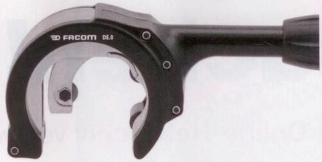
Facom hat einen neuen Auspuffrohrschneider mit Knarrenfunktion im Programm. Dieses Werkzeug ermöglicht es, die Abgasanlage einfach zu trennen. Der Knarrenmechanismus minimiert die Anstrengung, die unternommen werden muss, um ein noch am Fahrzeug montiertes Auspuffrohr abzuschneiden. Der Auspuffrohrschneider ist 250 Millimeter lang und für Rohrdurchmesser von 31 bis 65 Millime-
