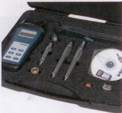
Das neue Kompressions- und Verlustdruckmessgerät Compri der Imes GmbH ermöglicht es, Kompressions- und Verlustdruck bei Benzin-, Diesel- und Gasmotoren zu messen und zu testen. Als Multifunktionsgerät konzipiert, erlaubt Compri aber auch, Drücke in allen flüssigen Medien am Motor zu messen. Das Gerät kann Drücke bis 70 bar erfassen. Der Sensor ist resistent gegen Dieselöl, Benzin, Schmieröl, Bremsflüssigkeit, Hydraulikflüssigkeit und natürlich Luft
