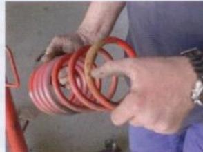
Bei der Probefahrt des Fiat 500 waren Geräusche hinten zu hören. Der Grund: Die Feder zeigt Korrosionsspuren, im Reklamationsfall dem Kunden zeigen.
