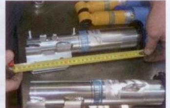
Die Stoßdämpfer im unmontierten Zustand messen und auf Schäden überprüfen.
