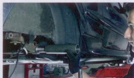
▲ Aufgetragene Schweißnaht zur Verringerung des Achszapfen-Innendurchmessers
