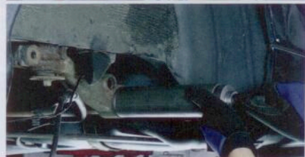
▲ Vorbereitung des Auszugs: Druckrohr, Endstück, Axiallager und Mutter werden über den Zapfen gestülpt
