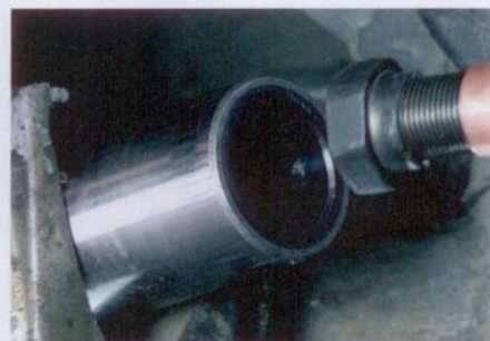
▲ Einführen von Mutter, Schutzhülle und Spindel in den verschlissenen Achszapfen
