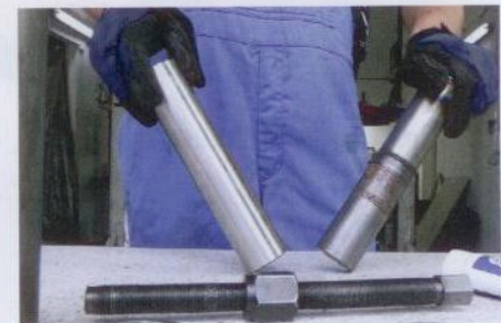
▲ Deutlicher Unterschied: Vergleich eines alten mit einem neuen Achszapfen
