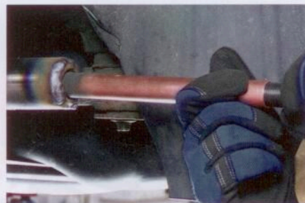
▲ Aufgetragene Schweißnaht zur Verringerung des Achszapfen-Innendurchmessers
