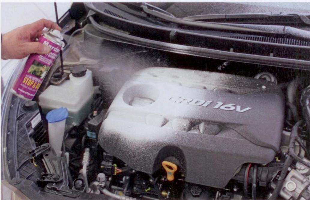
Um Fahrzeuge vor einem erneuten Marderbefall zu schützen, reicht es nicht, ein funktionierendes Abwehrsystem einzubauen. Vielmehr muss der Motorraum per Dampfstrahler oder mit einem speziellen Spray von den Duftspuren befreit werden. Bilder: Stop & Go, Ledermann
