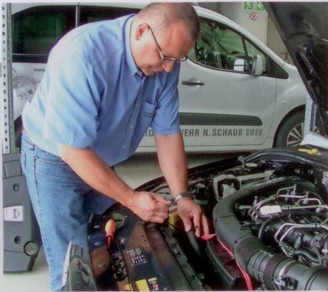
5 Stefan Schaub verlegt das Kabel im Motorraum und befestigt es. Hierbei sollte das Kabel nicht mit heißen Motorteilen in Berührung kommen.
