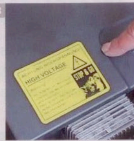
7 Das Batteriesiegel vom Marderabwehrgerät entfernen und überprüfen, ob die Funktions-LED vom Gerät leuchtet (hier mit optionalem Montagewinkel).
