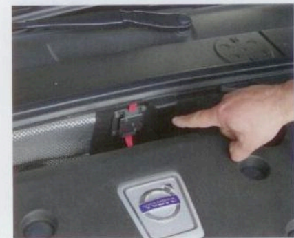
Die sechs Kontaktplatten werden an strategischen Punkten im oberen Motorraum verteilt eingebaut.
