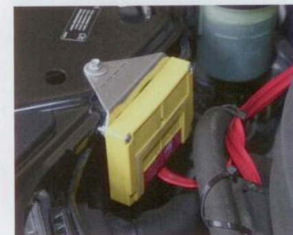
Die Montage der Hochspannungs-Mardergeräte von Stop & Go ist einfach. Ein Haltewinkel kann mitbestellt werden.
