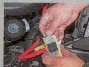
Zwei Knopfzellen sitzen im Steuergerät hinter einer Klappe. Sie müssen nach rund 18 Monaten getauscht werden
