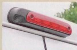
Nur ein Bauteil für Kamera und Bremslicht ist nötig.
